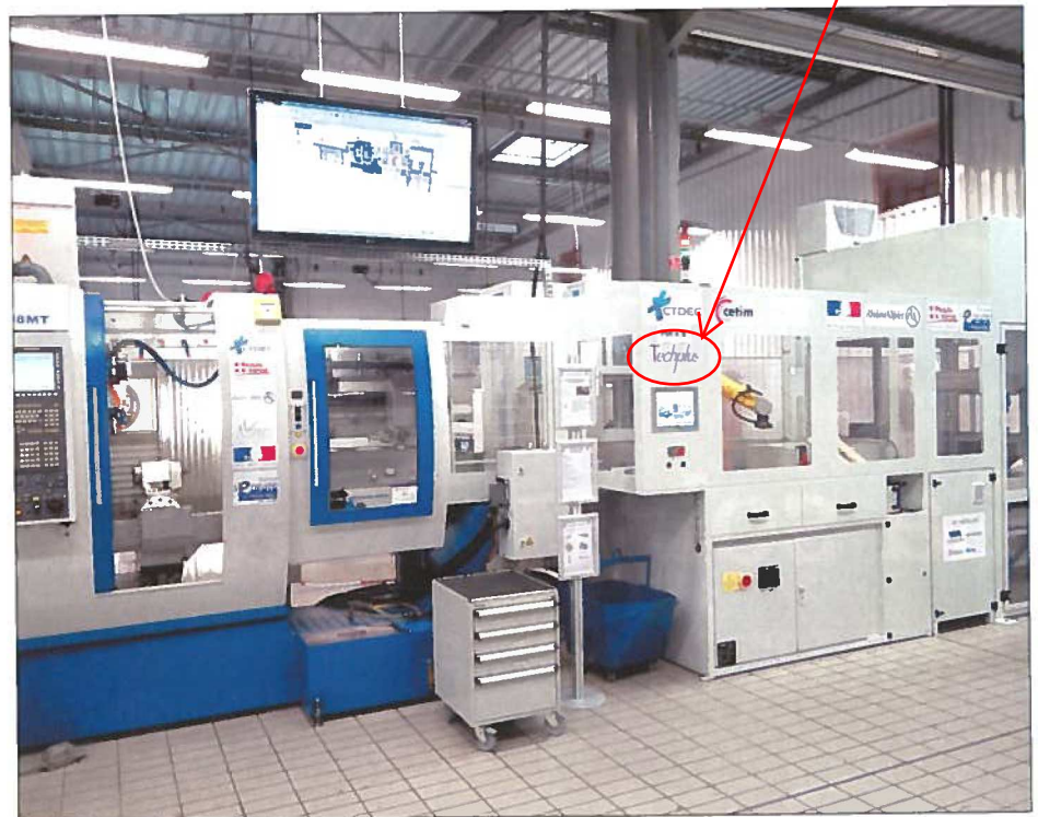
L'îlot de production autoadaptatif Usitronic dispose de capteurs intelligents qui autorisent une production "zéro défaut". Source : Cetim-Ctdec
